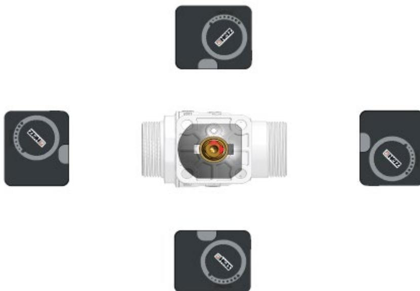
Se la valvola è installata in una cassetta, assicurarsi che vi sia uno spazio di almeno 45 mm tra il servomotore e il telaio della cassetta. Ciò consente la manutenzione e la sostituzione.
