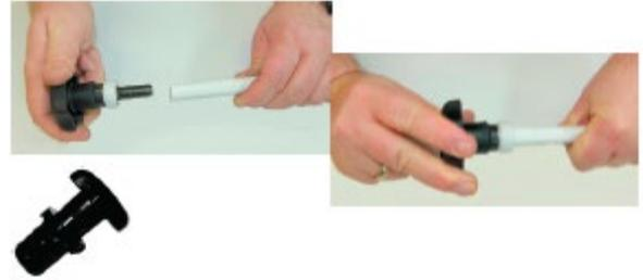
Posizionamento del raccordo sul tubo.
