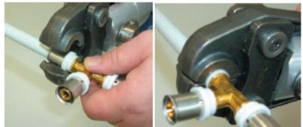
Gli strumenti di pressatura sono strumenti di precisione e devono essere gestiti di conseguenza. HERZ PipeFix viene pressato utilizzando il profilo "TH", in modo che possano essere utilizzati i consueti strumenti (pressore manuale, dispositivo di precisione, ecc.). Sono possibili piccoli intervalli "A" alla parete o al pavimento.
