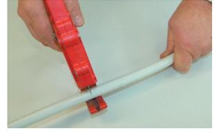
Il tubo viene rifilato e calibrato con uno speciale utensile adatto al suo diametro. I trucioli risultanti devono essere rimossi dall'estremità del tubo. Se il calibratore viene fissato su un trapano, non si devono superare i giri massimi di 10 giri/min.
