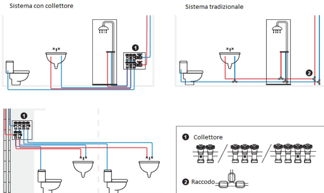
Il principale vantaggio del sistema con collettore rispetto al tipo tradizionale di impianto idraulico è la possibilità di ridurre il numero di giunti. In questo modo è possibile ridurre il potenziale rischio di perdite.
