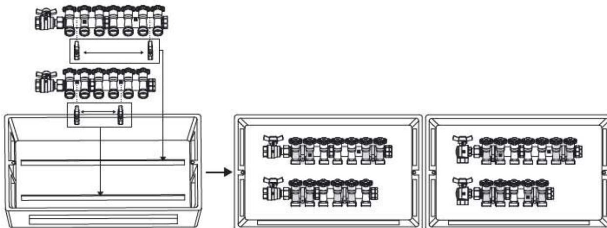
I tubi sono avvitati sui collettori per acqua potabile HERZ. I tubi devono essere allineati correttamente, quindi il collettore non è caricato con un momento flettente. Quando si utilizzano tubi in rame o plastica, tenere in considerazione i limiti di pressione e temperatura del materiale selezionato. In fase di montaggio utilizzare un idoneo attrezzo di montaggio che si adatti alle connessioni terminali dei collettori.
