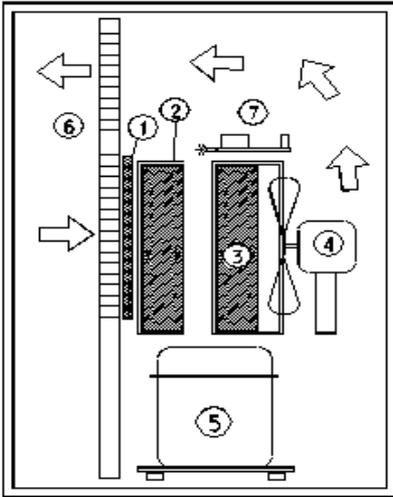
Con riferimento al disegno, ed immaginando di rimuovere la **griglia frontale (6)**, l'aria viene aspirata dalla parte centrale dell'apparecchio, attraversa nell'ordine il **filtro (1)**, l'**evaporatore (2)**, il **condensatore (3)** ed il **ventilatore (4)**; l'aria si porta nella parte posteriore verso l'alto e torna in ambiente.
