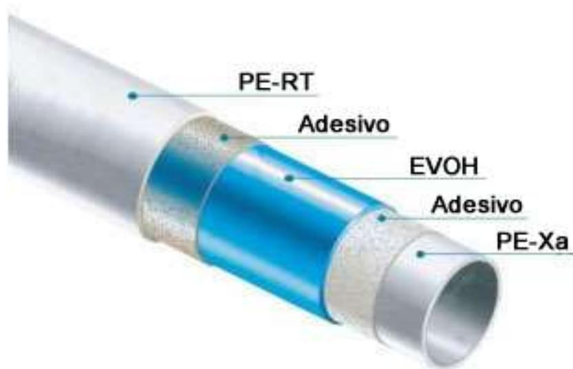
Il tubo multistrato IFLOOR PE-Xa è stato sviluppato per resistere alla vasta gamma di temperature e pressione nei sistemi ad acqua calda e fredda. Questo tubo è superiore alle tubazioni convenzionali ed è ideale sia per sistemi di riscaldamento radiante che per sistemi di raffreddamento radiante.
