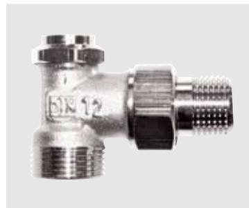
**2. AUTONOMIA.** Il detentore RL-5 è disponibile nelle dimensioni da 3/8", 1/2" e 3/4" nella versione nichelata dritta o a squadra ed esercita funzione di regolazione idraulica, intercettazione, riempimento e scarico, rendendo, in caso di necessità, ogni radiatore completamente autonomo rispetto all'impianto
