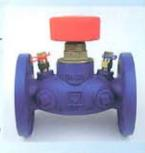
re. Questo regolatore di pressione è realizzato in lega di ottone resistente alla corrosione oppure in ghisa; membrane e o-ring sono in EPDM. Sopporta una pressione di esercizio massima di 10 bar, una pressione differenziale massima sulla valvola di 2 bar e una temperatura massima del flusso pari a 110°C.
