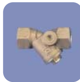
Filtro HERZ 4111 montato prima dei regolatori di pressione HERZ (larghezza delle maglie 0,4 mm) per proteggere da particelle di sporco dannose
